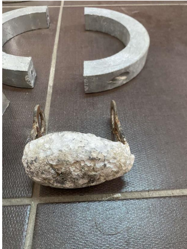
Διαιρούμενο ανόδιο αγωγού και ανόδιο τύπου χελώνας (μετά την χρήση του).
