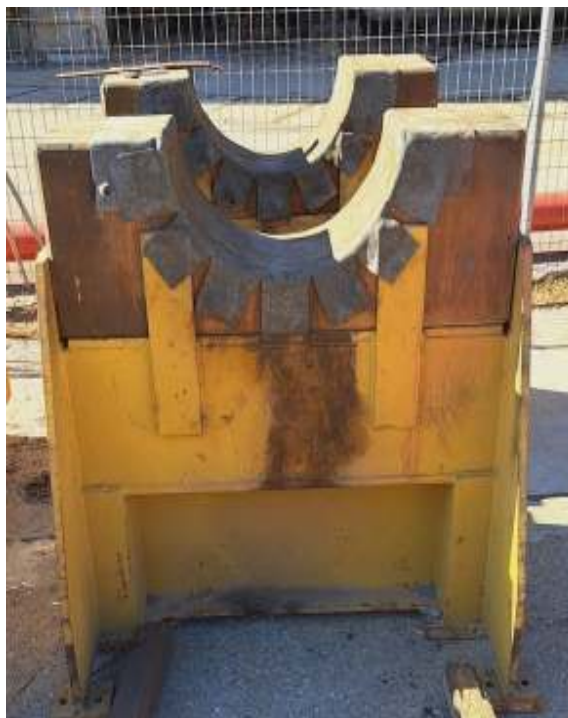
Καβαλέτα χαμηλά απόθεσης δρομέα γεννήτριας (σκαρίφημα Νο 5) (2 τεμάχια)
