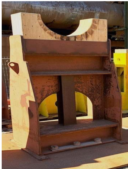
Καβαλέτο στήριξης – απόθεσης στροφείων βαθμίδος χαμηλής πίεσης (σκαριφήματα Νο 3 & 4)(4 τεμάχια)
