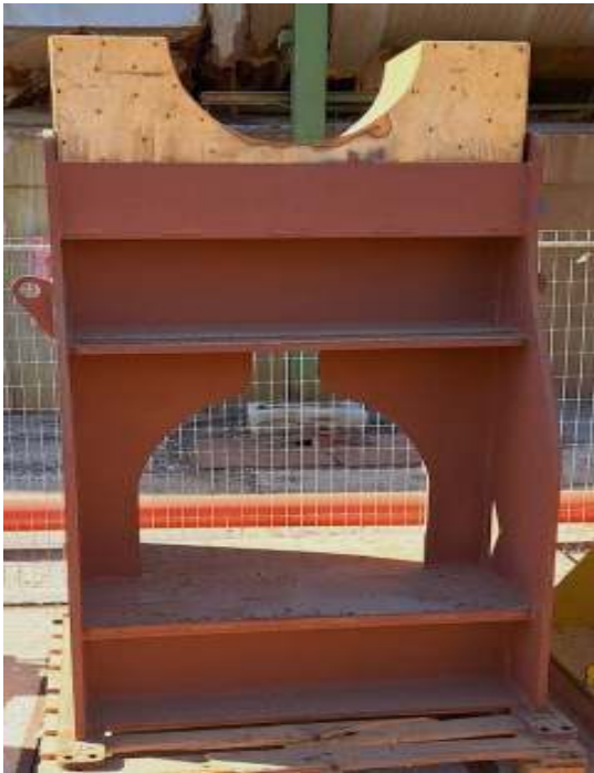
Καβαλέτο απόθεσης στροφείου υψηλής – μέσης πίεσης (σκαρίφημα Νο 2) (2 τεμάχια)
