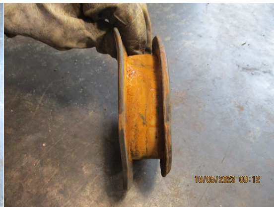
Σχήμα 2. Ελαστικό στεγανοποίησης για εναλλάκτη SONDEX
