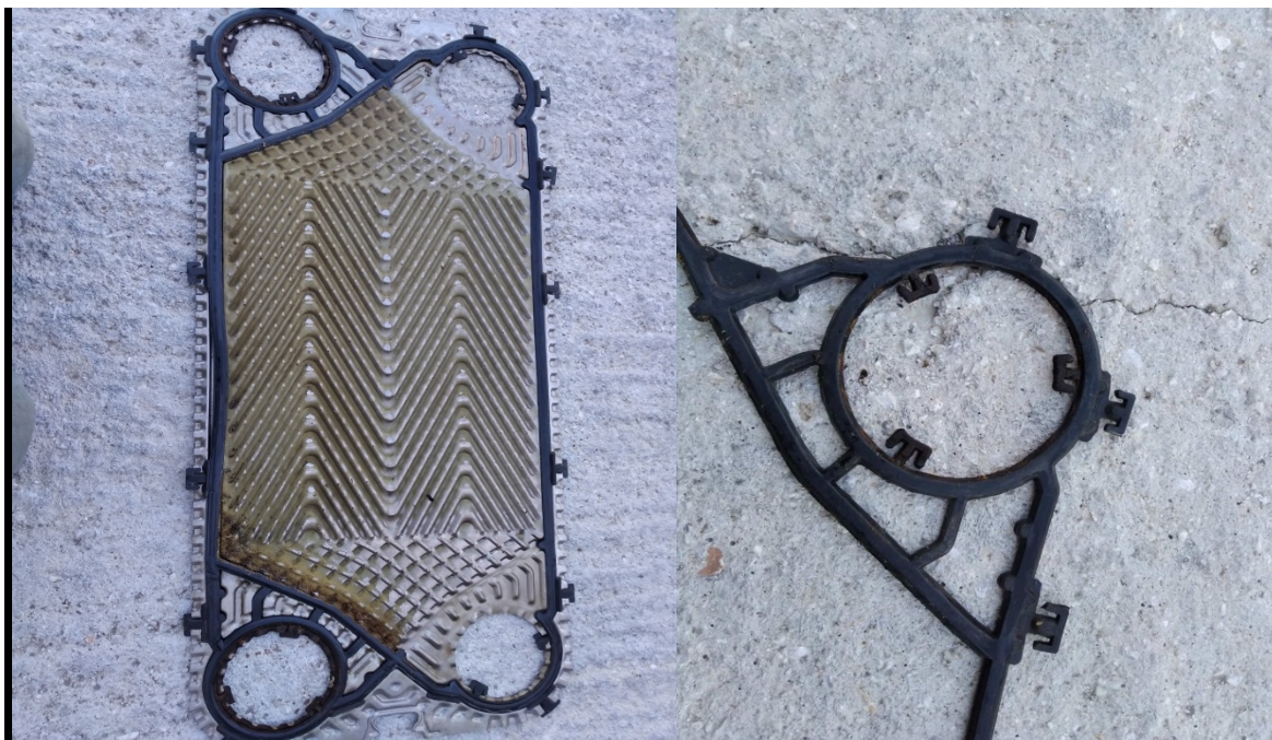
Σχήμα 1. Ελαστικό στεγανοποίησης για εναλλάκτη TEMPCO
