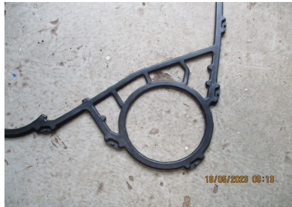
Σχήμα 2. Ελαστικό στεγανοποίησης για εναλλάκτη SONDEX
