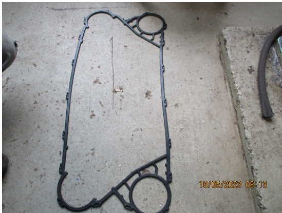
Σχήμα 2. Ελαστικό στεγανοποίησης για εναλλάκτη SONDEX
