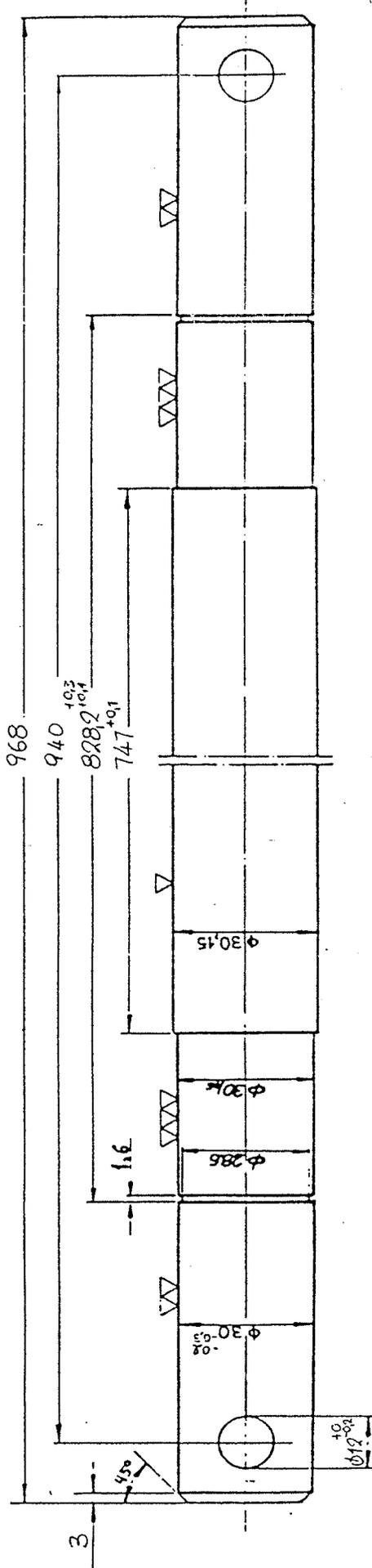
ΥΛΙΚΟ: ΧΑΛΥΒΑΣ S137-2E (DIN 1652)
