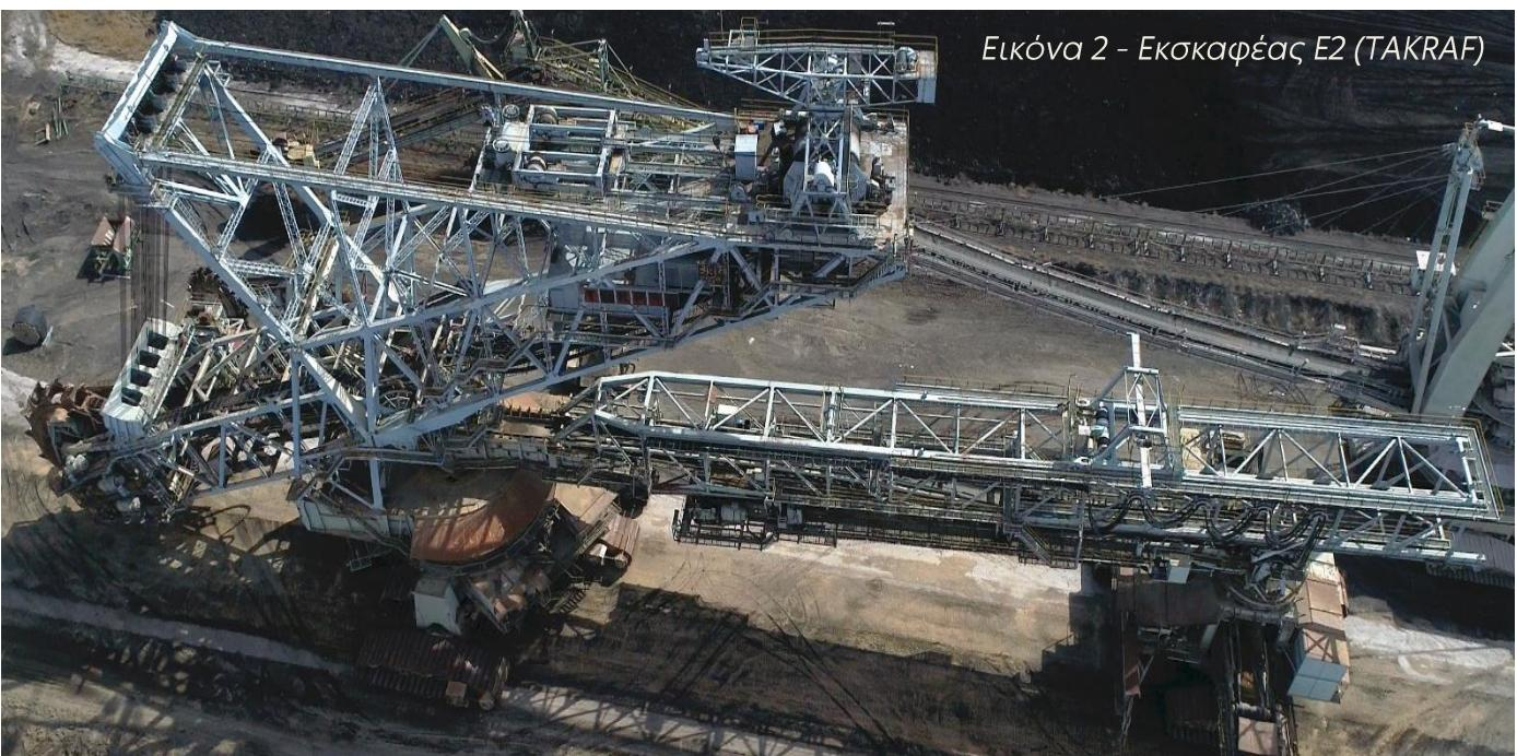
Πρόκειται για ερπυστριοφόρους καδοφόρους εκσκαφείς για υψηλή και χαμηλή κοπή, ο καθένας από τους οποίους αποτελείται από τα εξής κύρια μέρη:
