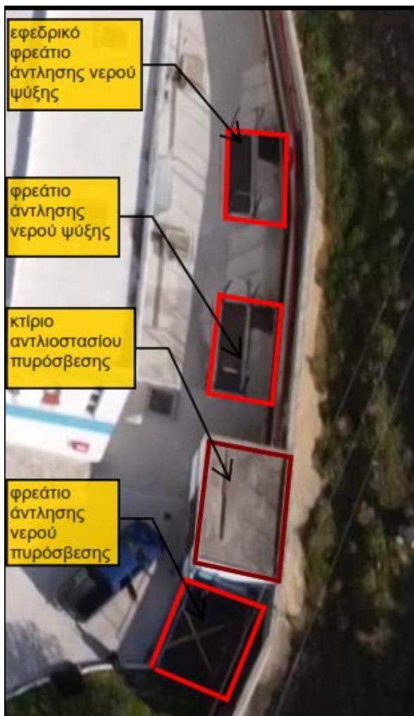
Φωτογραφία 2 Κάτοψη διάταξης φρεατίων άντλησης νερού πυρόσβεσης και ψύξης.
