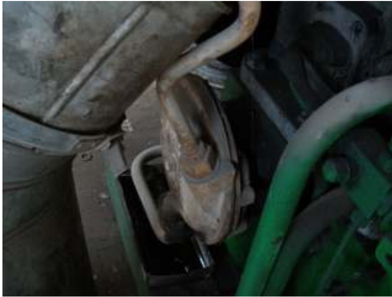
Φωτ. 11 . Ατμοστρόβιλος αντλίας λαδιού. Η αντλία λαδιού βρίσκεται στο εσωτερικό της πράσινης δεξαμενής.
