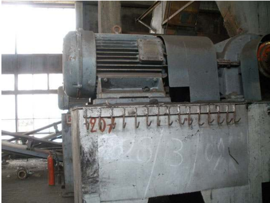
Φωτ. 102. Σπαστήρας φυσικού λιγνίτη. Κινητήρας πρώτου σταδίου πάνω στην βάση. Ο σύνδεσμος βρίσκεται κάτω από την λαμαρίνα προστασίας εμπρός από τον κινητήρα και πριν τον μειωτήρα.
