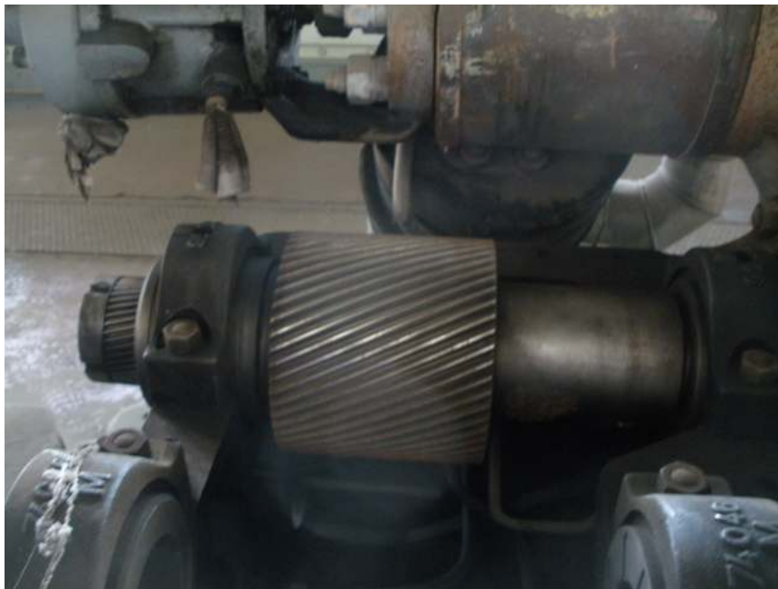
Φωτ. 13 . Πρωτεύον γρανάζι μειωτήρα και τριβείς άξονα στροβίλου.
