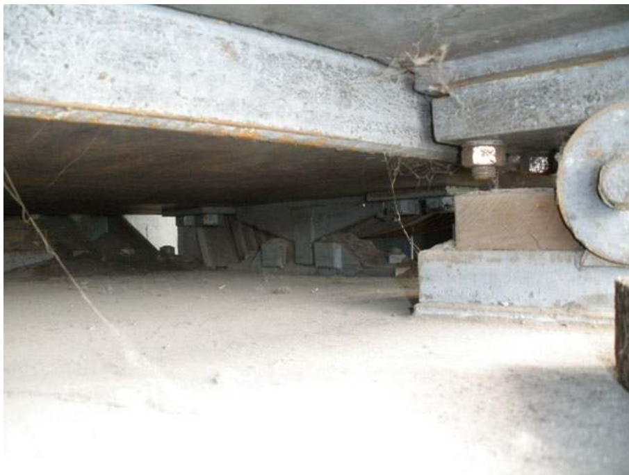
Φωτ. 72. Κόσκινο φυσικού λιγνίτη. Λεπτομέρεια του στηρίγματος ανεστραμμένου πρίσματος κάτω από την πλάκα δονήσεων.
