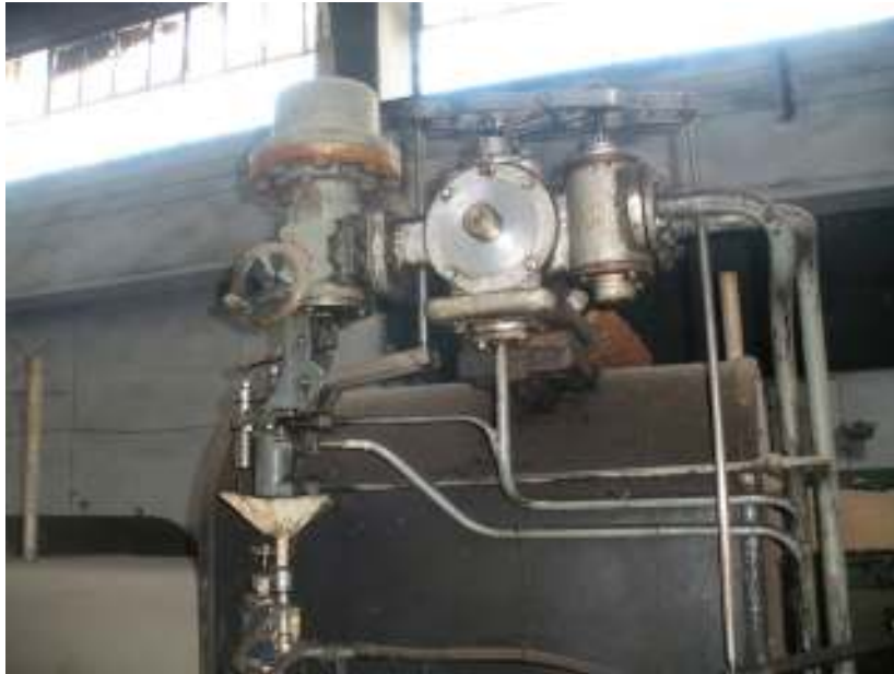
Φωτ. 25. Ρυθμιστής ισχύος. Λεπτομέρεια του υδραυλικού αποσβεστήρα ταλαντώσεων κάτω από το στοιχείο αντιπίεσης. Λεπτομέρεια δικτύων λαδιού (λεπτά δίκτυα) και του δικτύου ατμού (χονδρό δίκτυο).
