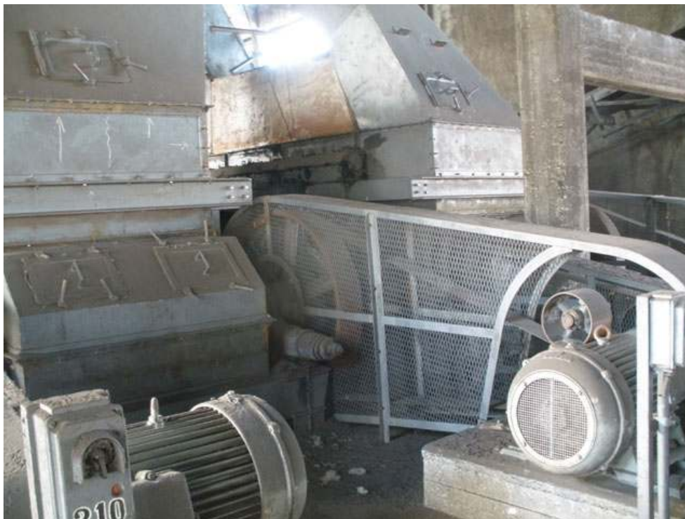
Φωτ. 109. Σπαστήρας φυσικού λιγνίτη. Ηλεκτροκινητήρες δεύτερου σταδίου και οι βάσεις τους.
