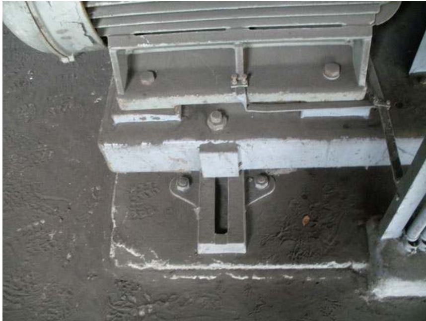
Φωτ. 98. Περιστροφικό κόσκινο. Λεπτομέρεια της γλίστρας τάνισης του ιμάντα κάτω από την βάση του ηλεκτροκινητήρα. Το επιδαπέδιο στοιχείο της γλίστρας πρέπει να συνοδεύει το μηχάνημα.
