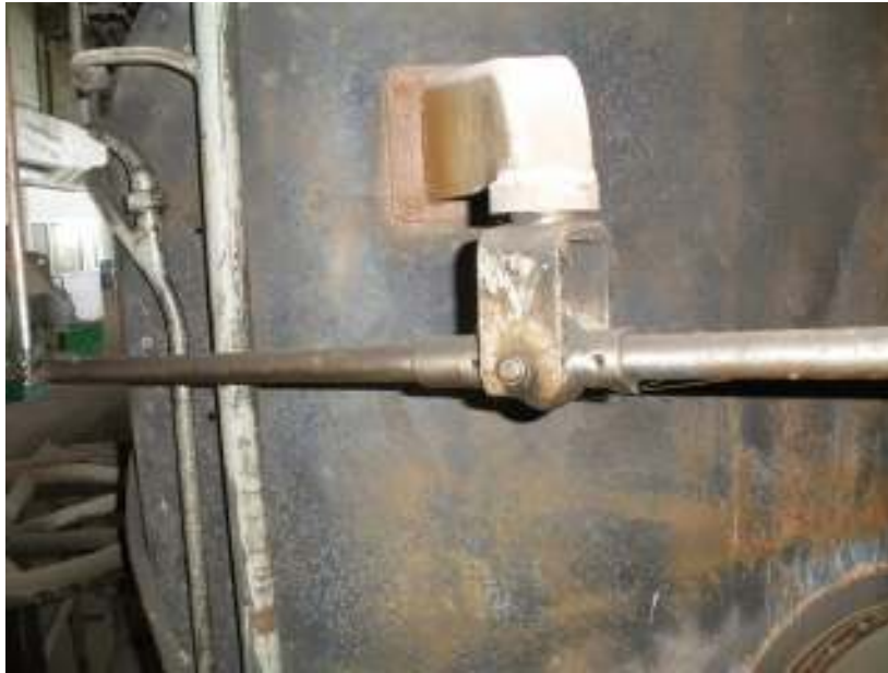
Φωτ. 23. Λεπτομέρεια της αρθρωτής στήριξης του μοχλού μετάδοσης εντολής από το φυγοκεντρικό στοιχείο στον γωνιακό κινητήρα του ρυθμιστή ισχύος.
