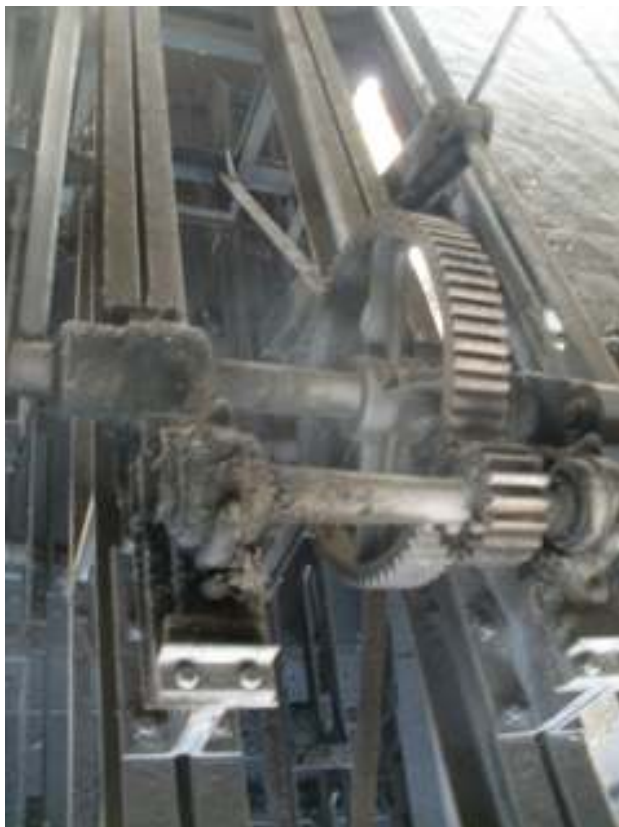
Φωτ. 62. Κόσκινο φυσικού λιγνίτη. Άνω τμήμα. Μηχανισμός κίνησης του ξέστρου. Τελικός μειωτήρας.
