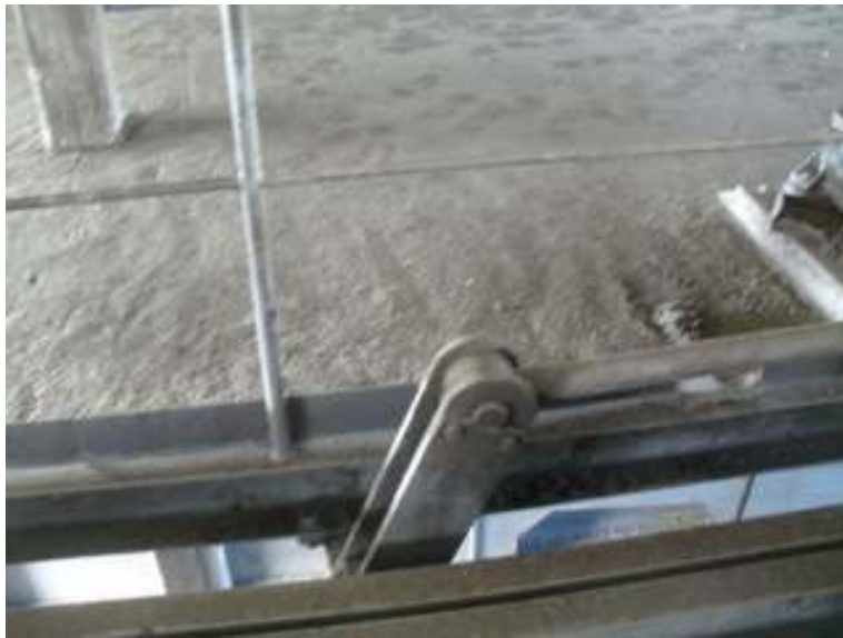
Φωτ. 63. Κόσκινο φυσικού λιγνίτη. Άνω τμήμα. Μοχλός μετατροπής κίνησης σε παλινδρομική.
