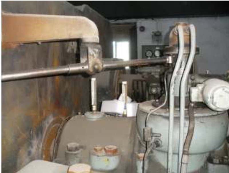
Φωτ. 21. Θερμόμετρο κυρίου τριβέα του άξονα στροβίλου και το φυγοκεντρικό στοιχείο του ρυθμιστή ισχύος.
