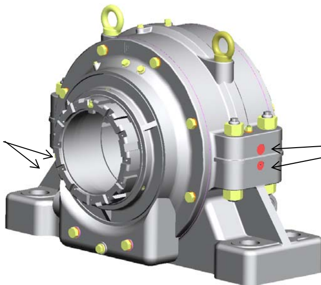
Abbildung 9, Mögliche horizontale Positionen des Schwingungsaufnehmers an Lagergehäusen
