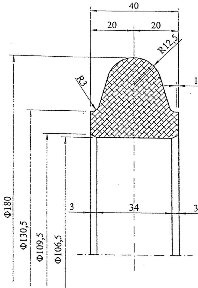
Υλικό: Ελαστομερής Πολυουρεθάνη.
