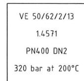
Auslegungsdruck 320 bar bei 200°C
